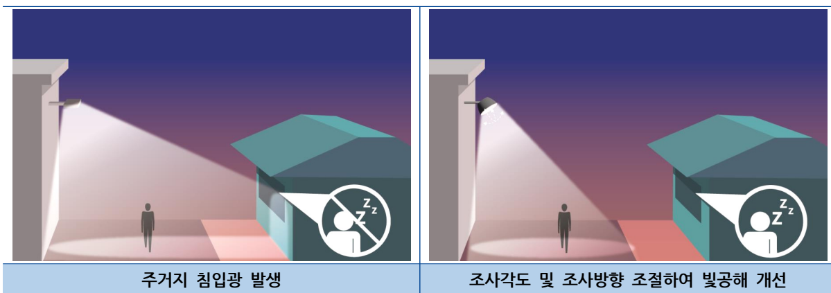
그림 4.2.6 조사각도, 설치방향 및 설치높이 조절
